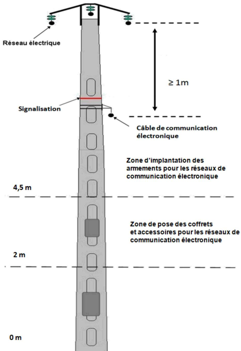
Les supports communs sont avant tout des supports de distribution d'énergie électrique sur lesquels les travaux doivent être exécutés selon les règles des « ouvrages » de la publication UTE C 18-510.
