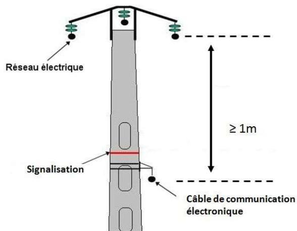
En particulier, les dispositions suivantes, concernant le réseau de communications électroniques en fibre optique installé sur des supports HTA, en conducteurs nus ou isolés, sont retenues :
