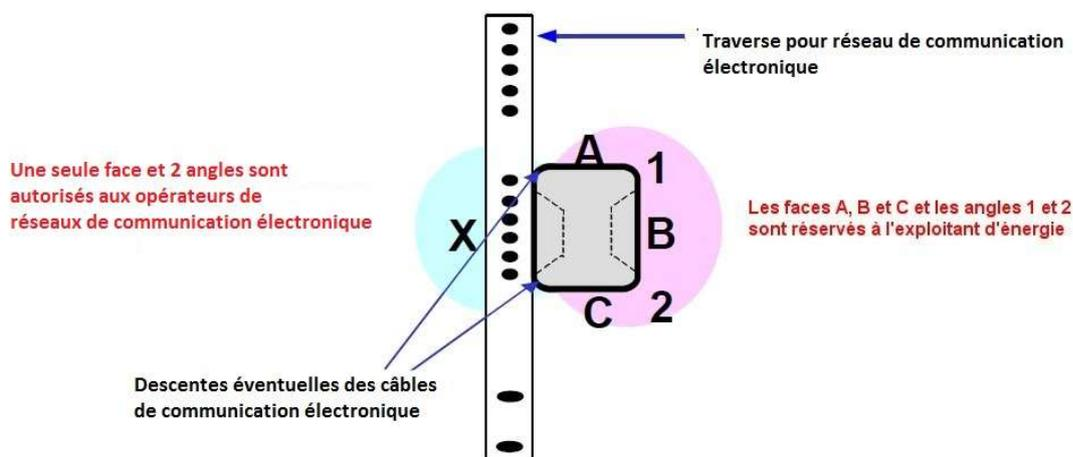
Figure 3 - Positionnement de la traverse télécom
