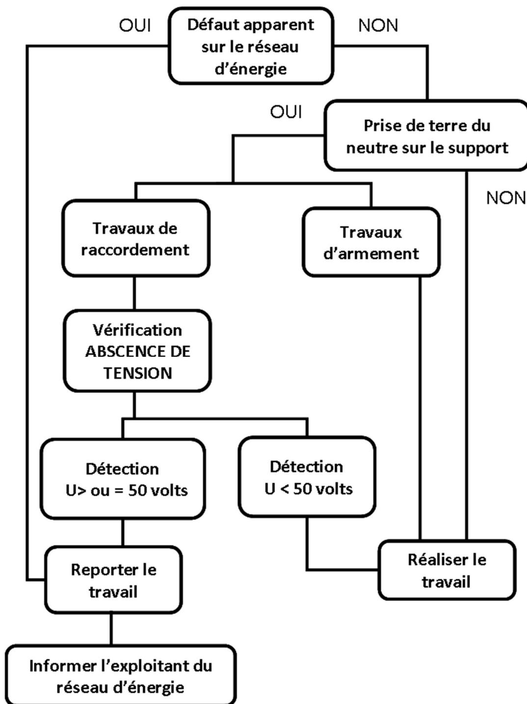
*Nota : Un appui commun ne peut comporter, à la fois, une prise de terre du réseau d'énergie et une prise de terre du réseau de communications électroniques.*
